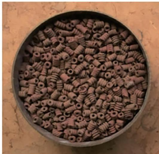
写真6 充填形試作触媒
