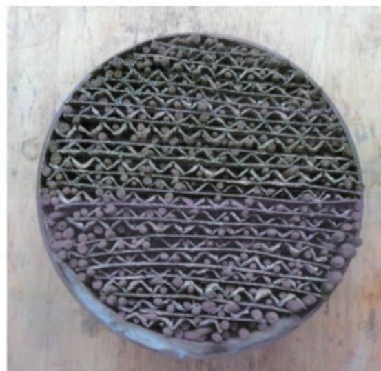
写真11. 写真10でステンレスメッシュにミラクレーを押し込んだのち、表面に触媒粉末を押し込んで成形・焼成した波状のものと平板で段ボール状にした試作触媒。大きな隙間には同様にして作った棒状の焼成触媒を入れている。( HC' -HM )
