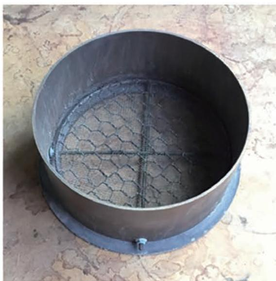
写真3 試験用触媒容器とドーナツ円形板 (下部)
