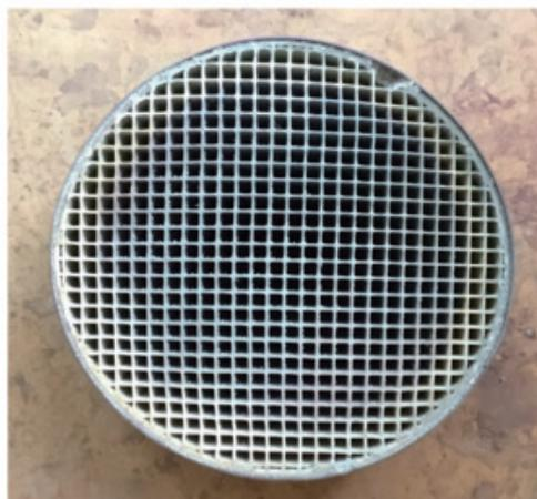
写真4 貴金属系触媒(セラミック製、
