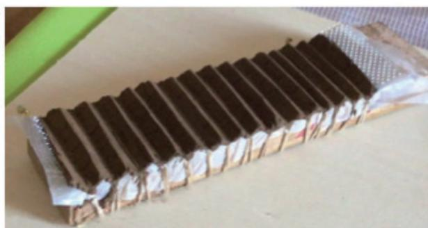
写真10. プラスチックフィルムとステンレスメッシュをV溝の上に置き、V溝に沿う形になるようタコ糸で縛り、その上から触媒粘土を押し込んだ。
