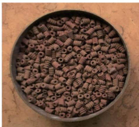
写真6 充填形試作触媒
