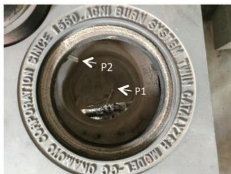
写真3 触媒前後のガス採取場所
