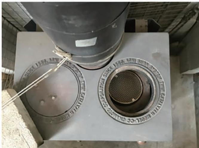
写真1 触媒の設置場所
