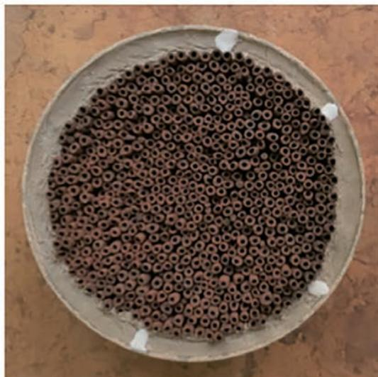
写真8 ハニカムに似た試作触媒
