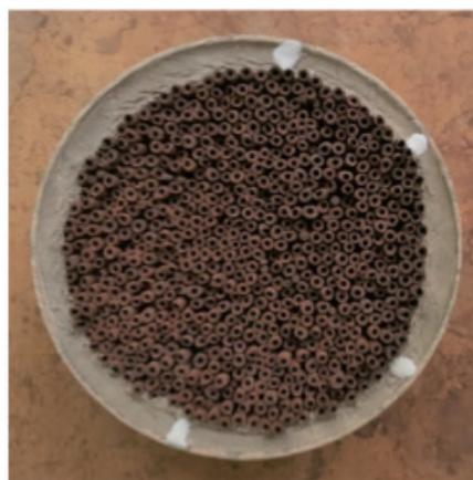
写真7 ハニカムに似た試作触媒
